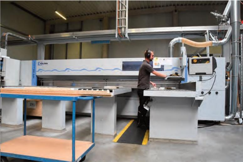
► Für spezielle Zuschnitte wird den Robotersägen jeweils eine halbautomatische Plattenaufteilsäge zur Seite gestellt, z.B. eine Sawteq B-300 (bisher: HPP 300 ProfiLine).
